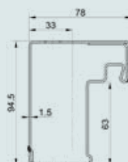
Typ 6.2 Dübelmontage vor der Öffnung (Mauerwerk / Beton)
