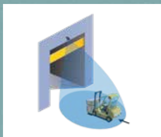
Ausblendung der Fussgänger, nur Fahrzeuge werden erfasst
