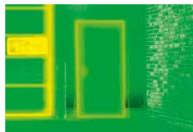
Perte d'énergie beaucoup plus faible, grâce à la porte avec rupture de pont thermique
