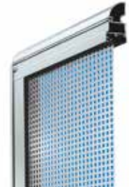
Tôle perforée en aluminium, section d'aération utile: env. 44 %
