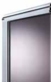
Frameprofiel met 19 mm dubbele kunststofbeglazing - grijs getint; lichtdoorlatendheid: ca. 43%
