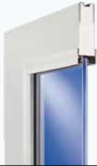
PMMA dubbel glas 18 mm, VSG 6 mm of dubbel gelaagd veiligheidsglas 21 mm dik (VSG/VSG), met aluminium glaslijsten.
