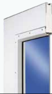
PMMA dubbel glas 18 mm, VSG 6 mm of dubbel gelaagd veiligheidsisolatieglas 21 mm dik (VSG/VSG), met stalen glaslijsten. Slagregendichtheid klasse 3, aanbevolen voor buitendeuren
