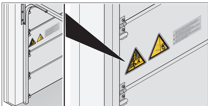
Abb. 1.2 Aufkleber am Torblatt anbringen
