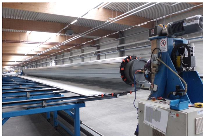
Les portes à enroulement d'une taille maximale de 11,5 x 12 mètres sont produites en série. Toutefois, des portes d'une largeur maximale de 18 mètres peuvent être réalisées sur demande.
