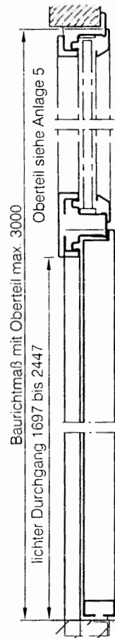
▲ Schnitt A2 - A2 Tür mit Oberteil (mit Kämpfer)
