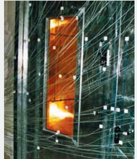
Essai de résistance au feu avec points de mesure pour la température.
