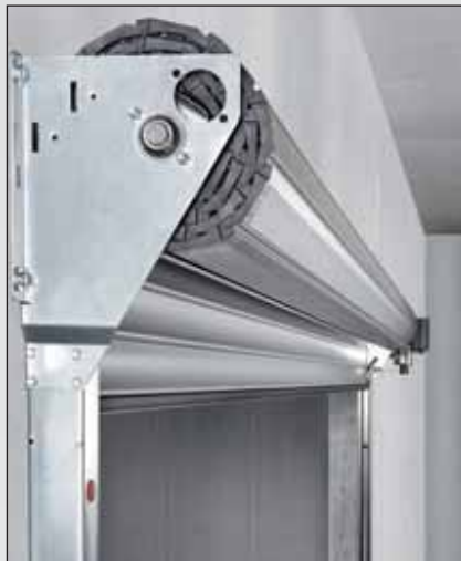
Pancerz bramy rolowanej jest zamontowany na wale nawijania i można go łatwo wbudować w konsolę. Niewymagająca wiele miejsca konsola jest skręcona z szyną prowadzącą – dzięki temu można zrezygnować z mierzenia i oznaczania.
