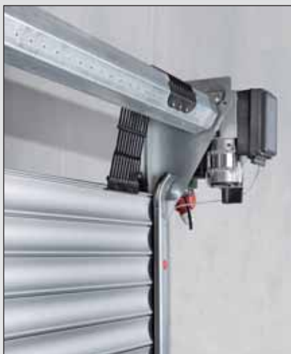
Lång livslängd på den höghållfasta sammansättningen mellan portmatta och portaxel. Oktagonaxel och axeltappar i varmförzinkat stål som standard.
