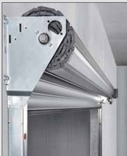
Portmatta och portaxel är förmonterade och kan problemfritt monteras direkt på konsolerna. De platsbesparande konsolerna är fastskruvade i löpskenorna – med det elimineras problematiska mätningar.
