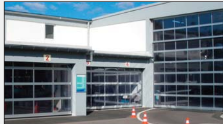
Typ SL – industriport av aluminium-ramprofiler med fönster.
