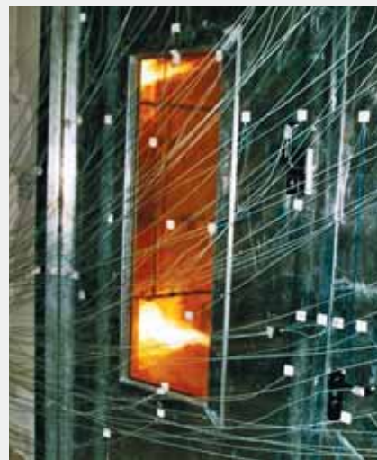
Brandtest med temperatur-mätpunkter.
