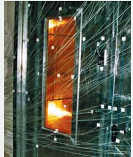
Požarni test z merilnimi točkami temperature.
