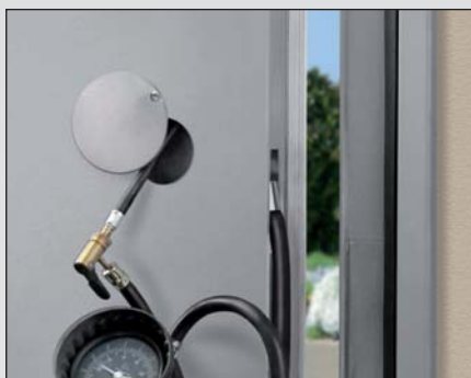
Nasadit kompresor za účelem napumpování třístranné těsnicí hadice.
