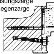
**Einbetonier Montage - Eckzarge**
