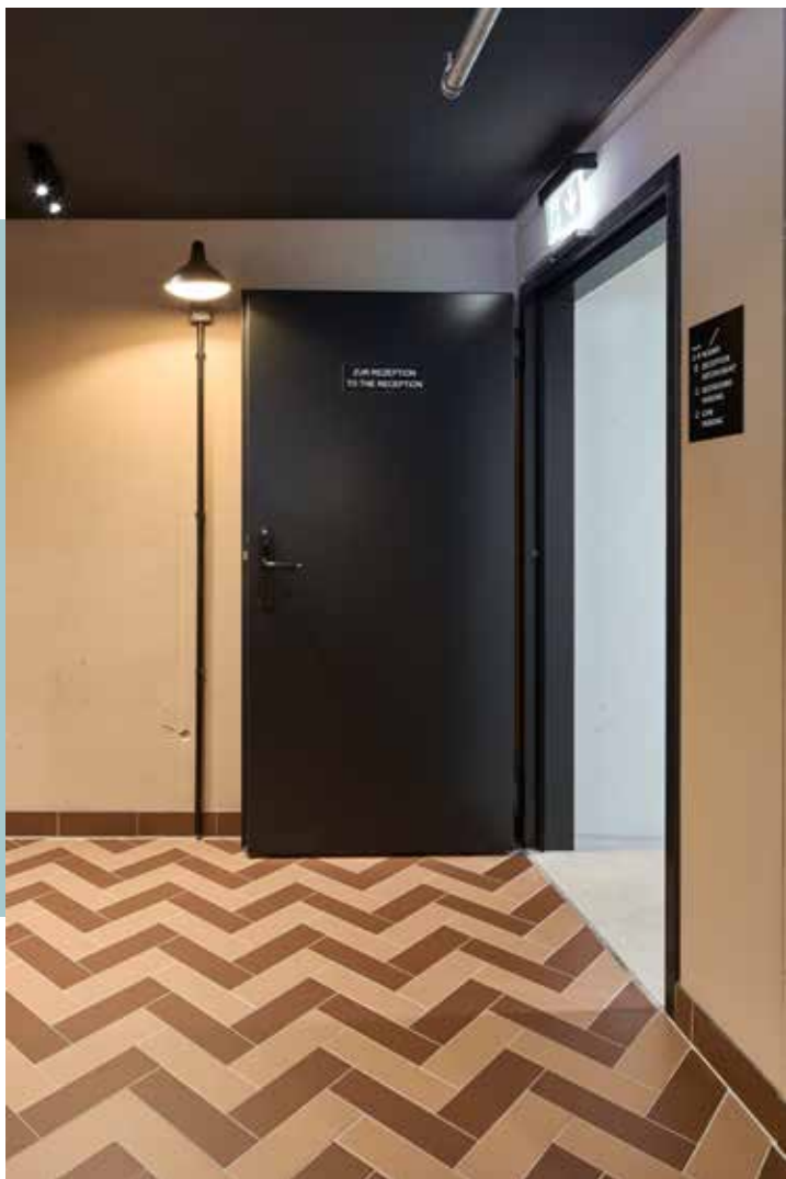
Türen mit Multifunktion finden sich unter anderem in den Erschließungswegen: Brandschutz, Fluchtweg und Ästhetik in einem Element vereint.
